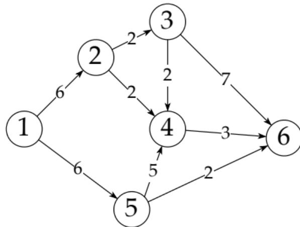
Узлы — это маршрутизаторы, рёбра — это каналы связи; с каждым узлом связана пропускная способность — узел 1 может передавать узлу 2 до 6 Мбит/с, узел 2 может передавать узлу 4 до 2 Мбит/с и т.д.
