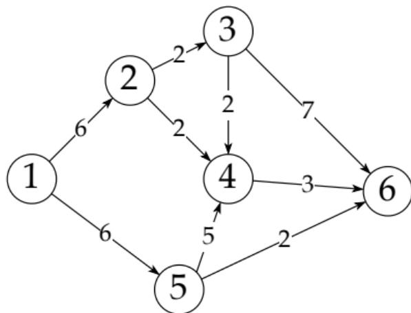
Узлы — это маршрутизаторы, рёбра — это каналы связи; с каждым узлом связана пропускная способность — узел 1 может передавать узлу 2 до 6 Мбит/с, узел 2 может передавать узлу 4 до 2 Мбит/с и т.д.
