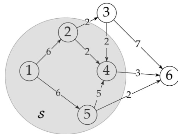
Рёбра в разрезе:  $1 \rightarrow 2, 4 \rightarrow 6$ , и  $5 \rightarrow 6$ , пропускная способность этого разреза равна  $6 + 3 + 2 = 11$ .
